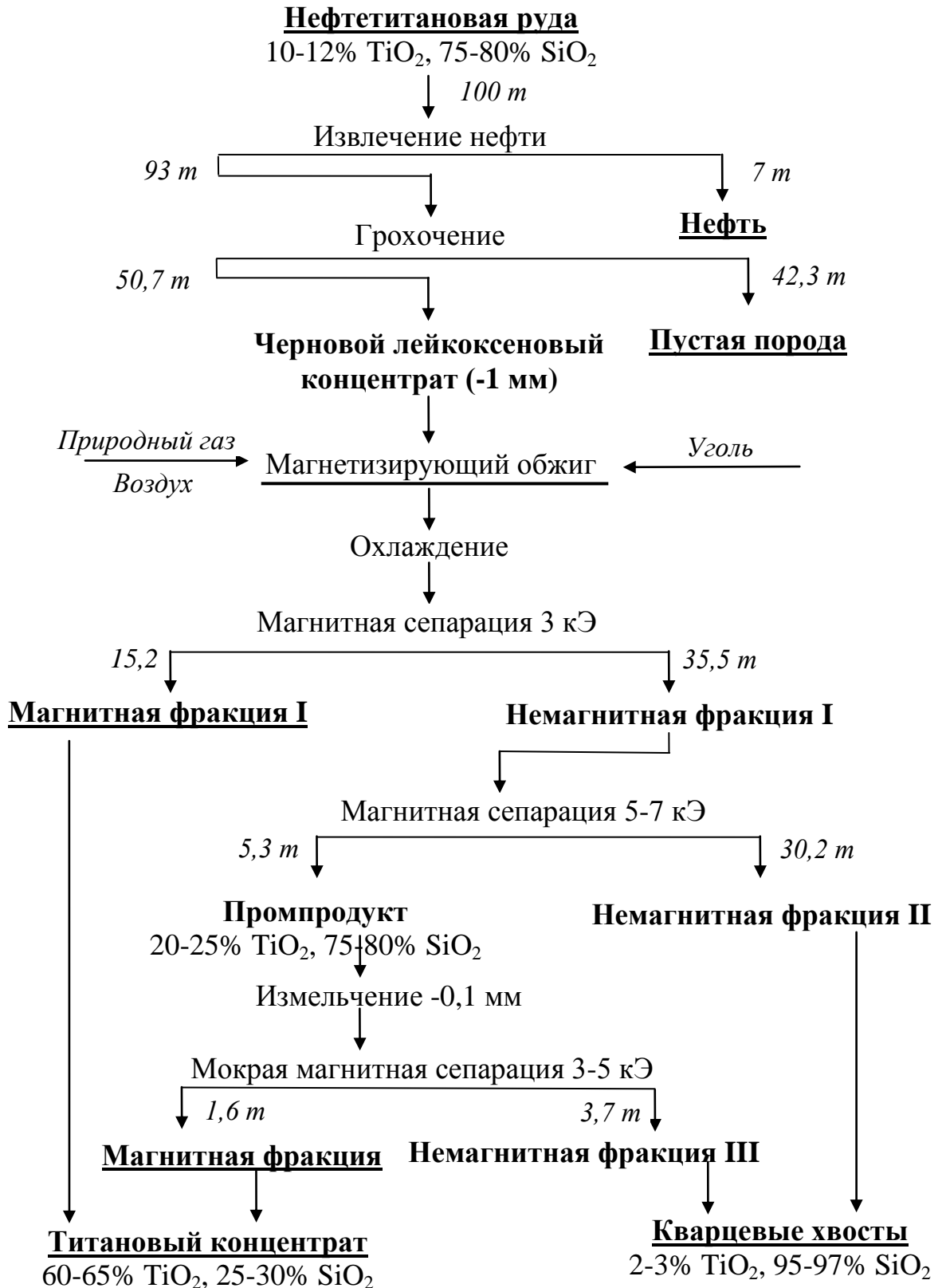
Рис. 4.6. Принципиальная технологическая схема переработки лейкоксеновой руды с указанием материальных потоков.
